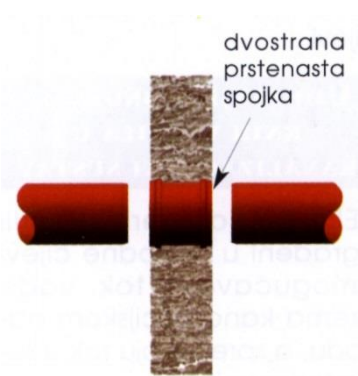
Jednostrani spoj (sa dvostrukom spojkom)
