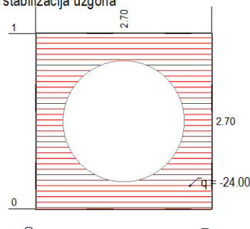
Opt. 3: Betonska stabilizacija uzgona
