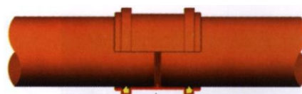
obujmica Vodonepropusne gumene brtve umetnute u utore na spojki
