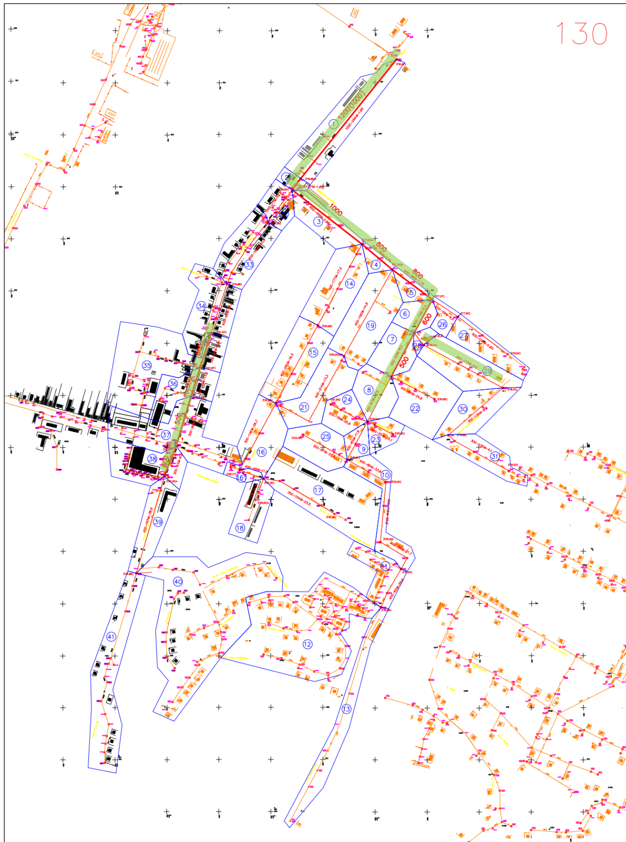
Slika 7 Hidraulička shema za intenzitet oborine i = 130 l/sec/ha
