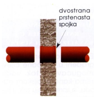
Jednostrani spoj (sa dvostrukom spojkom)
