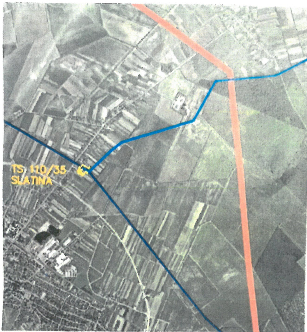
Prilog 1: prikaz trasa postojećih nadzemnih vodova DV 110 kV Našice-Slatina i DV 110 kV Slatina-Virovitica i TS 110/35/10 kV Slatina, te trasa planiranih nadzemnih vodova DV 2x400 kV Ernestinovo-Žerjavinec (dionica Koprivnica-Krndija) i DV 110 kV Slatina-Donji Miholjac na području aglomeracije Slatina (istočno područje)
